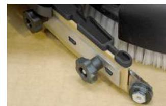
Tergipavimento parabolico, facile sostituzione delle lame in gomma. Il piatto spazzole oscillante e il tergilavaggio garantiscono la giusta pressione di pulizia su qualsiasi tipo di pavimento.
